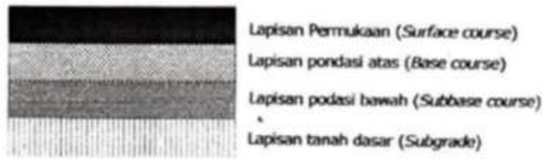
Gambar 2. Bagian Lapisan Kontruksi Perkerasan Jalan
