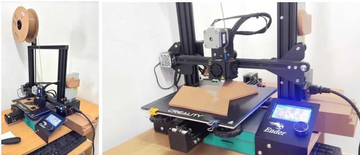
**Gambar 8.** Proses pembuatan prototype menggunakan alat printer 3D
