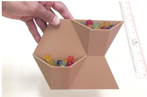
**Gambar 13.** Prototipe panel skala 1:1 bisa menampung banyak hidrogel
