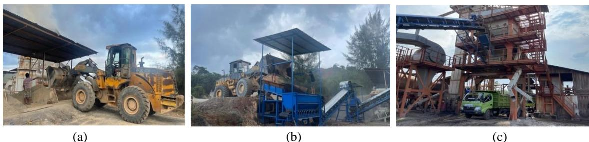
**Gambar 3** (a) Pengangkutan material ke *Cold Bin* (b) Pengangkutan Asbuton ke *Cold Bin* (c) Pengangkutan Material Aspal (AC-BC)
